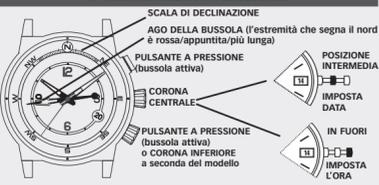
L'orologio viene spedito con una protezione attorno alla CORONA CENTRALE. Rimuovere la protezione e spingere in dentro la CORONA CENTRALE per iniziare. La bussola va calibrata prima dell'uso per assicurare la precisione ed evitare letture inaccurate. Andare a www.timex.com/expedition per assistenza nella calibrazione. L'orologio incorpora la tecnologia a sensore magnetico della Precision Navigation, Inc., di Mountain View, California, USA.
