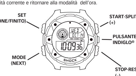
Funzioni dei pulsanti mostrate con le funzioni secondarie fra parentesi!
